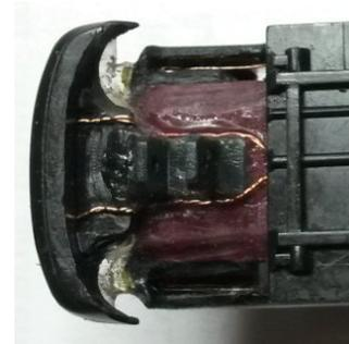
Im Bild links ist die elektrische Kabelführung abgebildet (im folgendem Kapitel gibt es eine größere Abbildung dazu).
